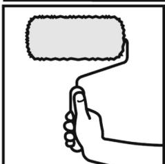
Nur Vlies-Rollkleister gem. Herstellerangaben ansetzen und gleichmäßig, bahnenweise mit der Kleisterrolle direkt auf die Wand rollen.
